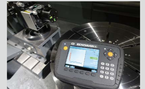
RENISHAW直線度 / 平行度 / 垂直度雷射檢驗儀 Parallelism / Straightness / Perpendicularity (RENISHAW)
